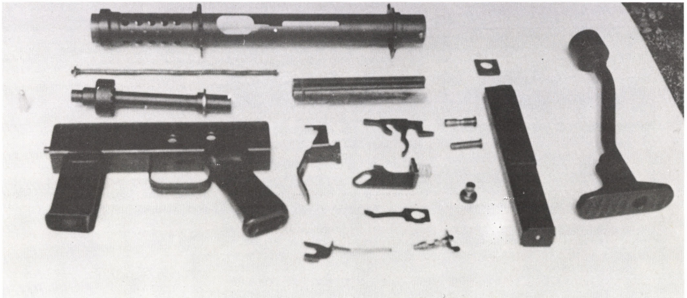
De conception simple, le pistolet mitrailleur URU se démonte en 17 pièces en moins de 45 secondes.
