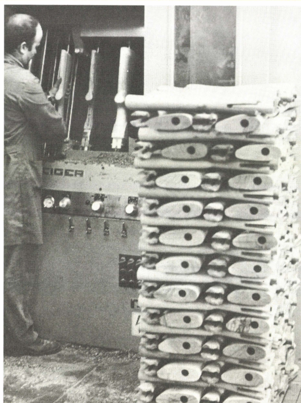
Découpe des crosses au pentographe.
