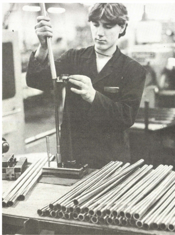
Poste de mesure de variation de profil des canons.
