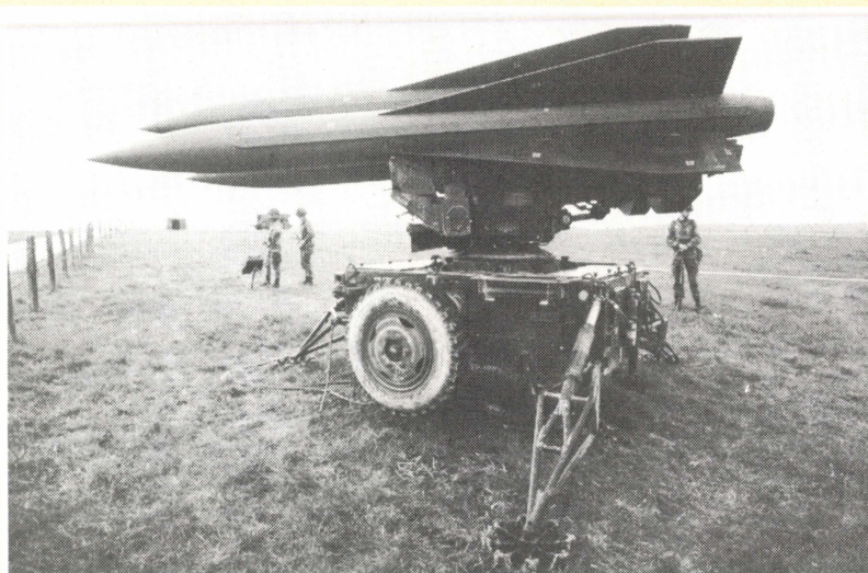
Chaque corps d'armée possède un régiment de Hawk à 4 batteries de 6 affûts triples. Le Hawk est capable d'atteindre un objectif volant à 18 000 m. Principal défaut de ce matériel, chargé de la protection haute altitude : son manque de souplesse.
